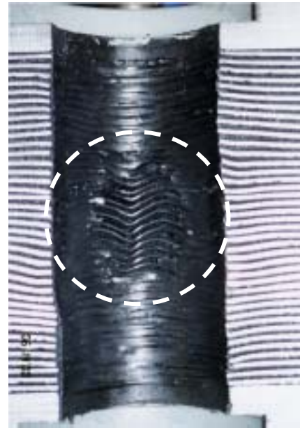
写真2 RB 試験体中心部分での中間鋼板の面外変形 (加振平行面)
