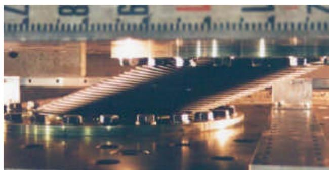
写真2 積層ゴムの水平変形状態
