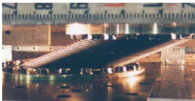
写真2 積層ゴムの水平変形状態 (積層ゴム直径50cm, 圧縮力600ton, 水平変形40cm)
