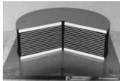
写真4.3.1 積層ゴムアイソレータのカットモデル
